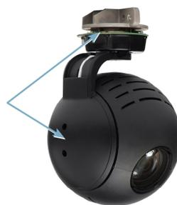
AXIS P54 攝影機直接連接到兩個馬達的驅動軸 (圖中左側所示)——一個可進行平移，另一個可上下移動攝影機。AXIS P54 耐用的水平/上下控制系統無須經由皮帶或是齒輪之類的零件即可快速移動，是一款可靠、低維護需求的 PTZ 攝影機。
